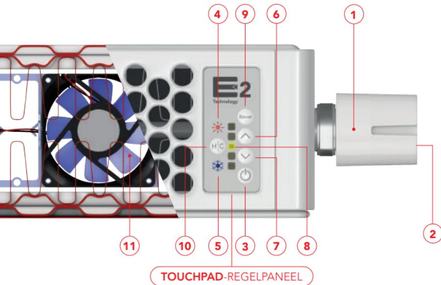
**1** elektronischer Stellantrieb mit Verbindungs-kabel
